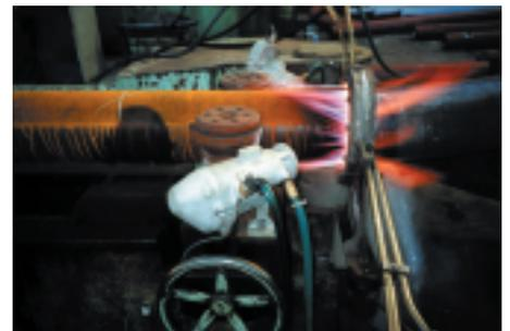
曲げ工程でのサーマラット使用例(サーモジャケット装着)
